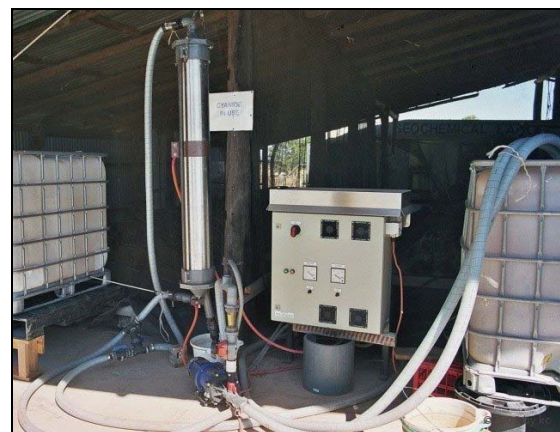
Testzelle, Netzteil, Pumpe und Zyanidbehälter
